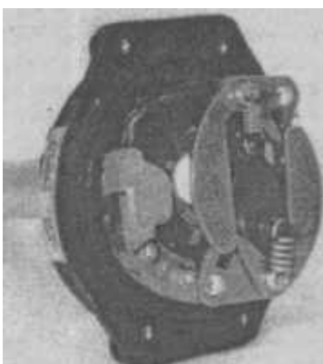
Вакуумный регулятор. Распределитель MSD поставляется с набором пружин, который позволяет конструктору добиться кривой опережения зажигания требуемой формы.
